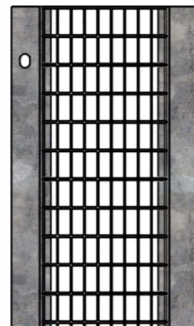
GRIGLIA ZINCATA ANTITACCO D.M 236/89 MAGLIA 30x15 dimensioni: 206x25x1000 mm
